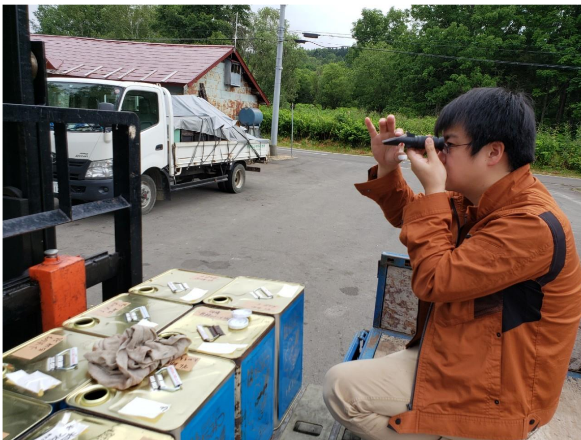
蜂蜜の糖度を測り品質を確認する。国産蜂蜜は77度以上が合格ライン。
